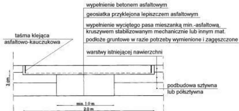
Rys. 3. Naprawa głęboka pojedynczego pęknięcia odbitego, w przypadku braku dobrego podparcia krawędzi pęknięcia
