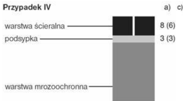
2.3. Konstrukcja nawierzchni dla kategorii ruchu R 2 – grubość warstwy w [cm]
