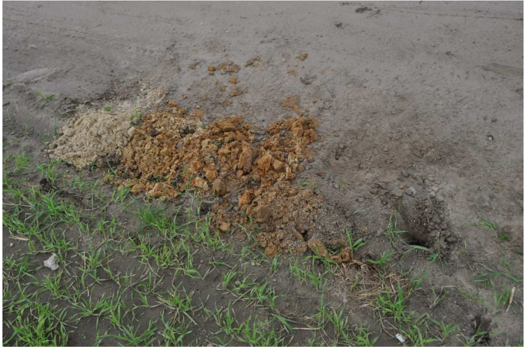
Wykonywanie odwiertów ul. Reymonta 20cm humus, 30cm piasek, 50cm piasek gliniasty, 20cm piasek z cząstkami gliny, 15cm piasek gliniasty, 65cm piasek wzorcowy barwy białej wody gruntowej nie nawiercono
