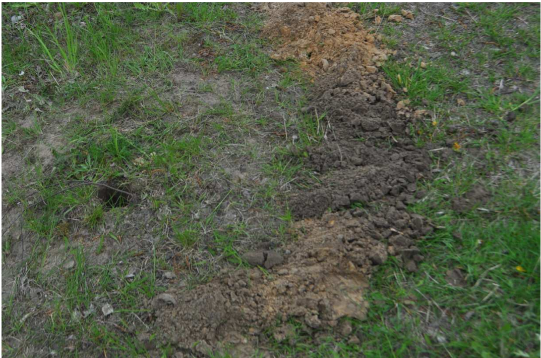
Wykonywanie odwiertów ul. Reymonta 20cm piasek z małą ilością ziemi, 100cm piasek z dużą ilością ziemi poniżej 120cm piasek wzorcowy
