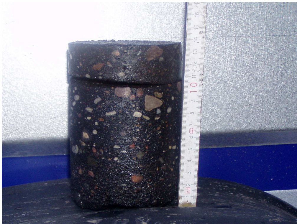
Km 3+300 nawierzchnia bitumiczna gr. 3+10,5cm
