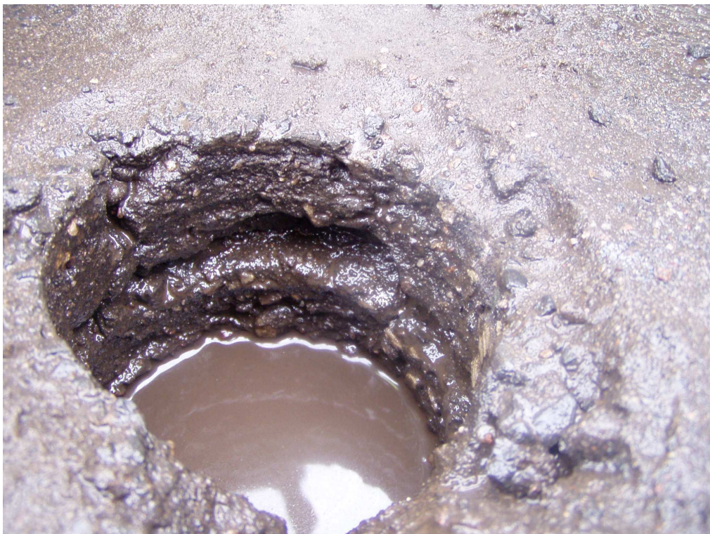
Km 2+300 próbka gr. 9cm rozsypała się podczas wiercenia
