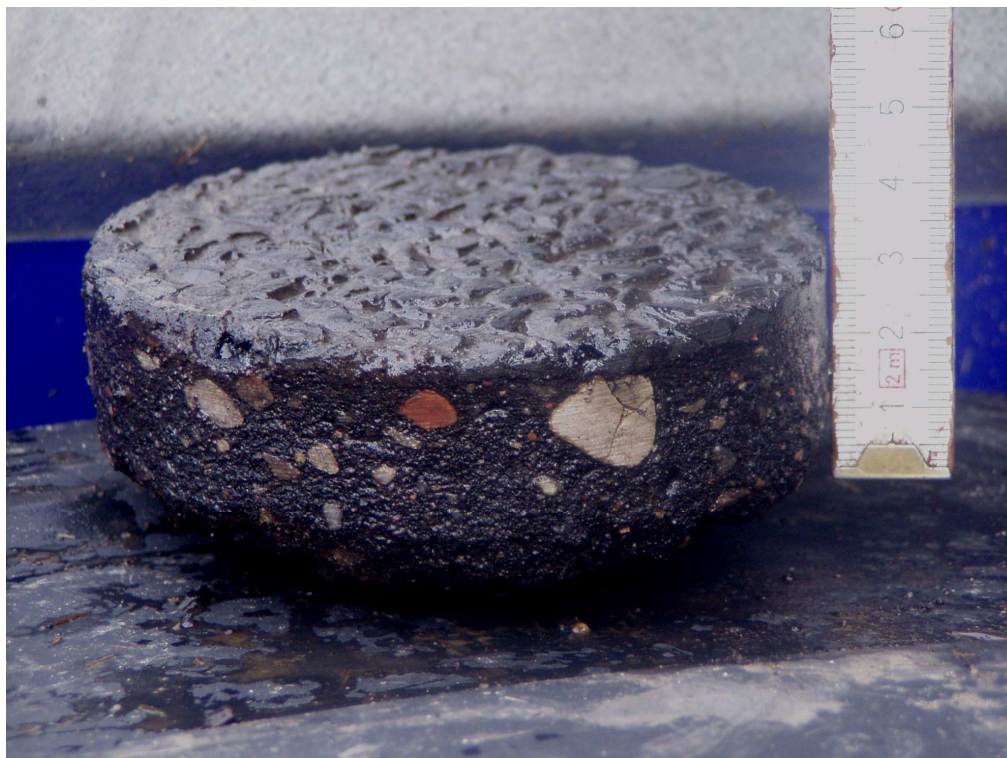
Km 2+700 miejscowość Ostrów nawierzchnia bitumiczna gr. 3cm
