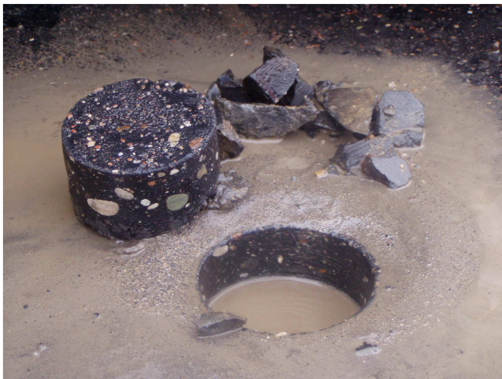
Km 3+900 nawierzchnia bitumiczna gr. 5cm
